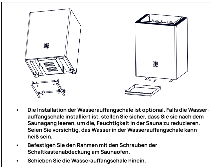
Abbildung 10. Installation der Wasserauffangwanne mit dem Rahmen.
